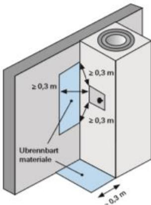
Feie-/sotluke må ikke komme nærmere brennbare materialer enn 0,3 meter og gulv under luke må beskyttes (plater av ubrennbart materiale kan benyttes).
